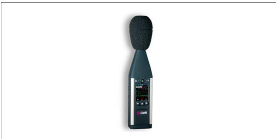
Εικόνα 5. Ηχόμετρο 01 dB Fusion class 1 smart noise monitor , που χρησιμοποιήθηκε για τις μετρήσεις.
